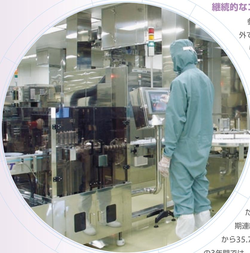
「ディンプルボトル」製造ラインの検査工程。1本1本の容器の形状がコンピュータでチェックされます。
