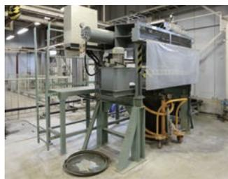
汚泥脱水処理装置
