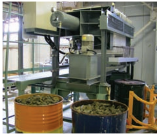
排水脱水設備（能登工場）
