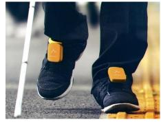
同システムは、スマートフォンの専用アプリと器具が連動します。目的地を音声入力すると、GPS(全地球測位システム)などを利用して経路を検索し、"音声"ではなく足への"振動"で道案内をしてくれます。例えば、靴に装着したデバイスがスマートフォンから信号を受信、右折なら右足、左折なら左足、直進なら両足の装置が振動し、曲がり角に近づくとその間隔が短くなるなどの仕組みです。
